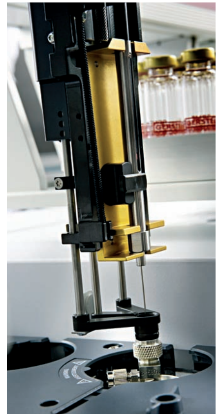
Abbildung 7: Automatisierte SPME-HS-Probenaufnahme mit dem GERSTEL-MPS-Bioscreen. Durch den Einsatz der SPME-Headspace-Analytik wird die Sensitivität um das 480-fache erhöht.
